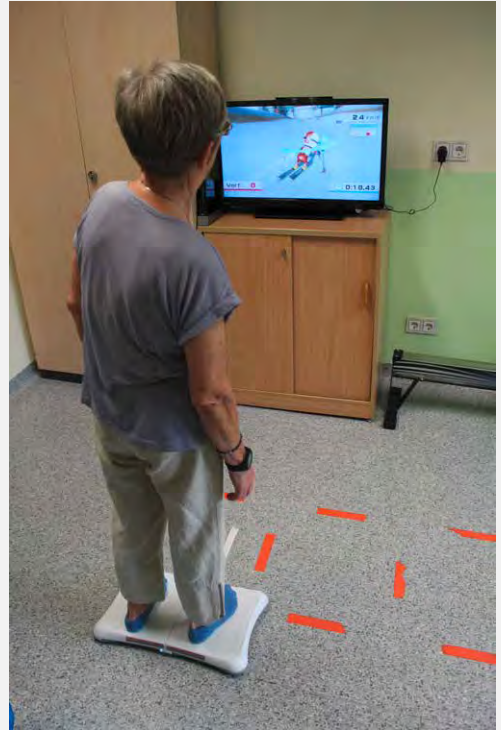
Abbildung 1 Virtuelle Skiabfahrt mit dem Nintendo Wii® Balanceboard im Rahmen einer onkologischen Studie. Die Körperschwerpunktverlagerung der Probandin wird durch das Balanceboard erfasst und auf die Figur im Spiel übertragen.
